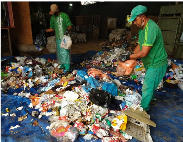
Figura 9 - Rompimentos dos sacos.
