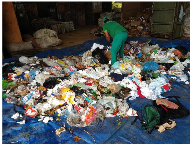
Figura 10 - Homogeneização dos resíduos.
